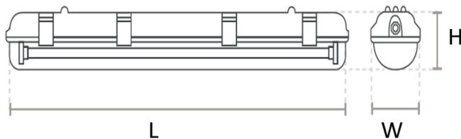
Los componentes se entregan por separado (Luminaria+Tubos) por lo que requiere ensamble final en sitio para su instalación.
